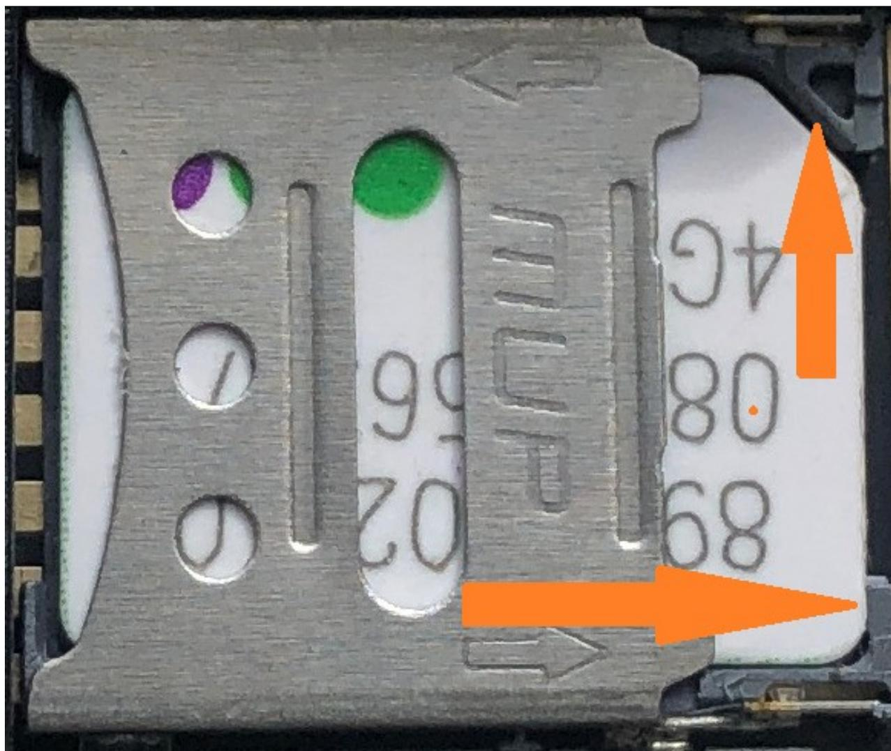
**Обратите внимание после закрытия слота симкарты, Срезанный уголок симкарты должен быть расположен максимально плотно к срезанному уголку слота симкарты. (Допустимый зазор ориентировочно до 1 мм).**
